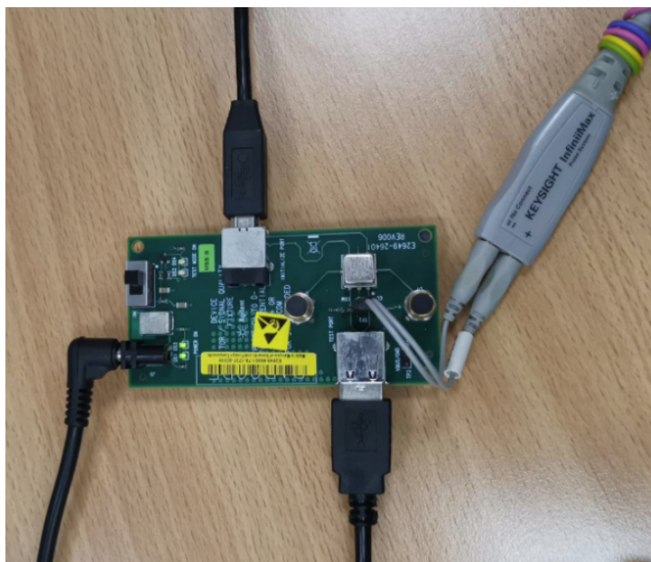
图 6: High-Speed Device 信号质量测试连接示意图
